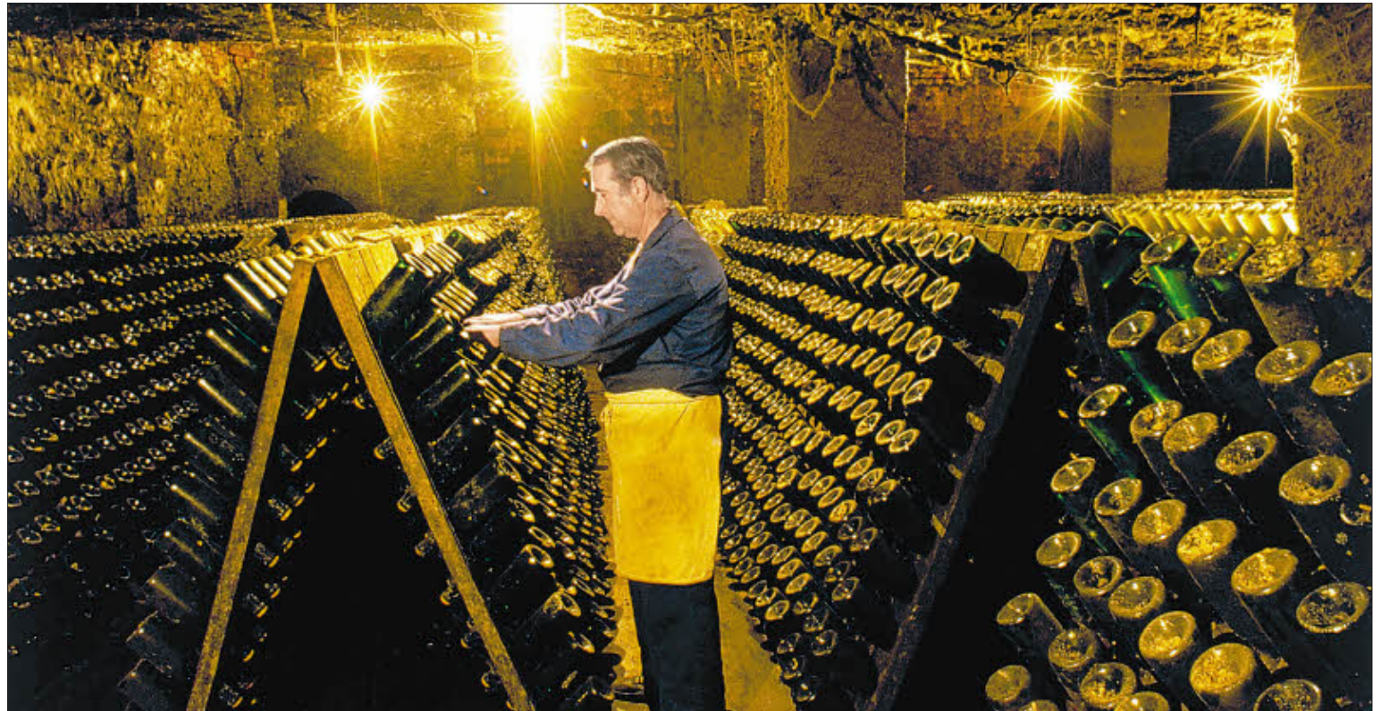
Die Schaumweinflaschen werden gedreht. Die Hefe sammelt sich im Flaschenhals. So kann sie später gefroren und entfernt werden. Bild: SN/CARLOS NAVAJAS/ICEX
