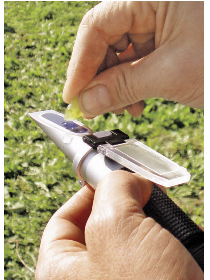
Winzer Peter Malberg liest in seinem Weingarten in Spitz in der Wachau die Mostgrade der Trauben – also ihren Zuckergehalt – mit einem Refraktometer ab.
