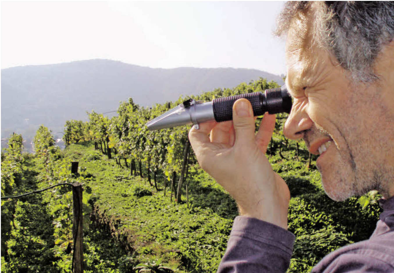
Winzer Peter Malberg liest in seinem Weingarten in Spitz in der Wachau die Mostgrade der Trauben – also ihren Zuckergehalt – mit einem Refraktometer ab.
